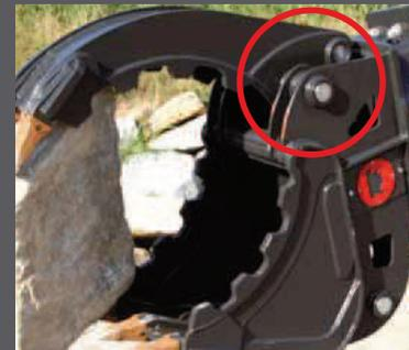
Der Greifarm ist so konstruiert, dass die Technik geschützt im Gehäuse untergebracht ist. Zudem ermöglicht die Bauweise große Öffnungsweiten von bis zu 2200 mm.
